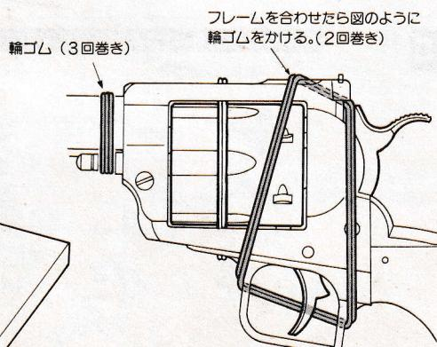
組み込んだ各部品が飛び出さないよう注意して
